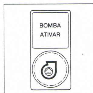
Fig. 34/2 Botão Ativação da instalação da bomba de extinção
