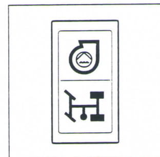
Fig. 34/3 Lâmpadas-piloto Tomada de força e Prontidão para operação da bomba
