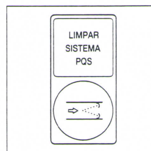
Fig. 61/3 Lâmpada-piloto Advertência - Lavagem da instalação de pó
