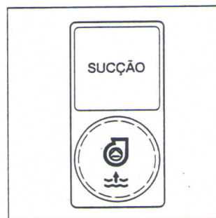
Fig. 41/1 Botão Sucção de Água externa
