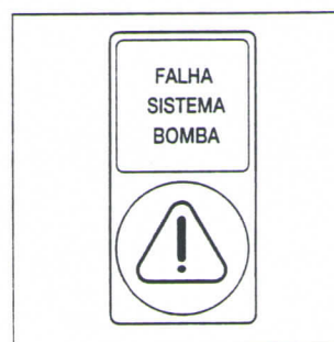
Fig. 37/2 Lâmpada-piloto Advertência central
