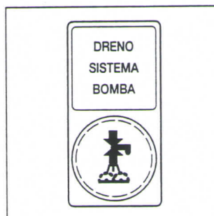
Fig. 52/1 Botão Drenagem do sistema da bomba
