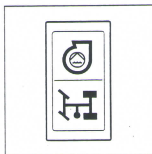
Fig. 35/1 Lâmpadas-piloto Tomada de força e Prontidão para operação da bomba
