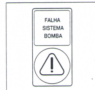
Fig. 58/5 Lâmpada-piloto Advertência central
