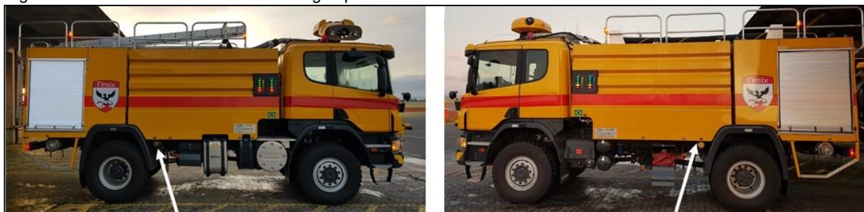
Figura 125: Bocal de Abastecimento de Água por Pressão
