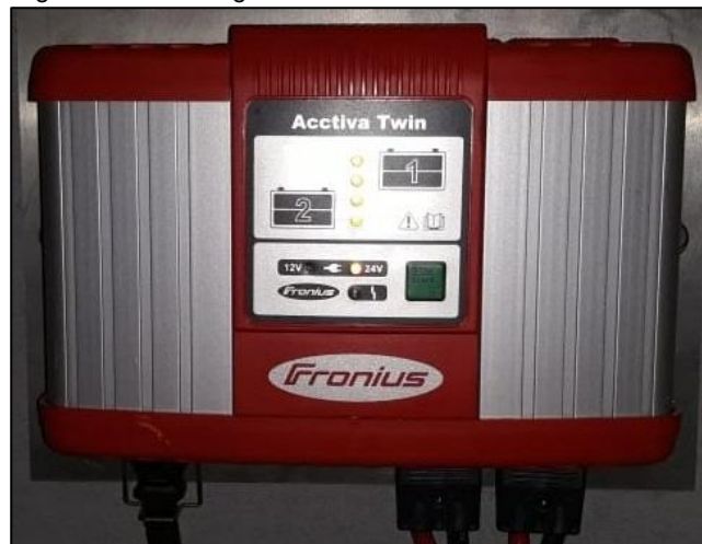
Figura 77: Recarregador de Baterias
