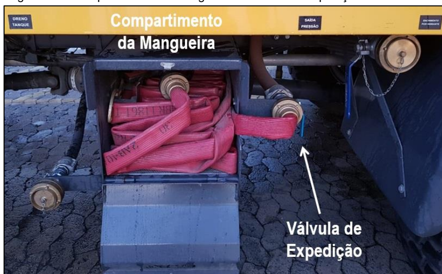
Figura 108: Compartimento da Mangueira e Válvula de Expedição
