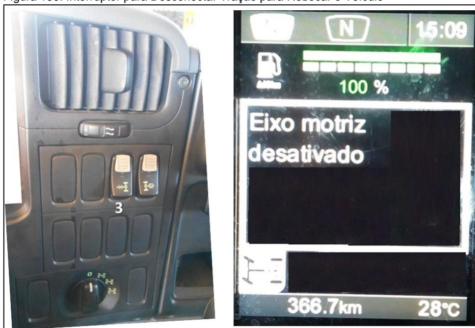
Figura 130: Interruptor para Desconectar Tração para Rebocar o Veículo
