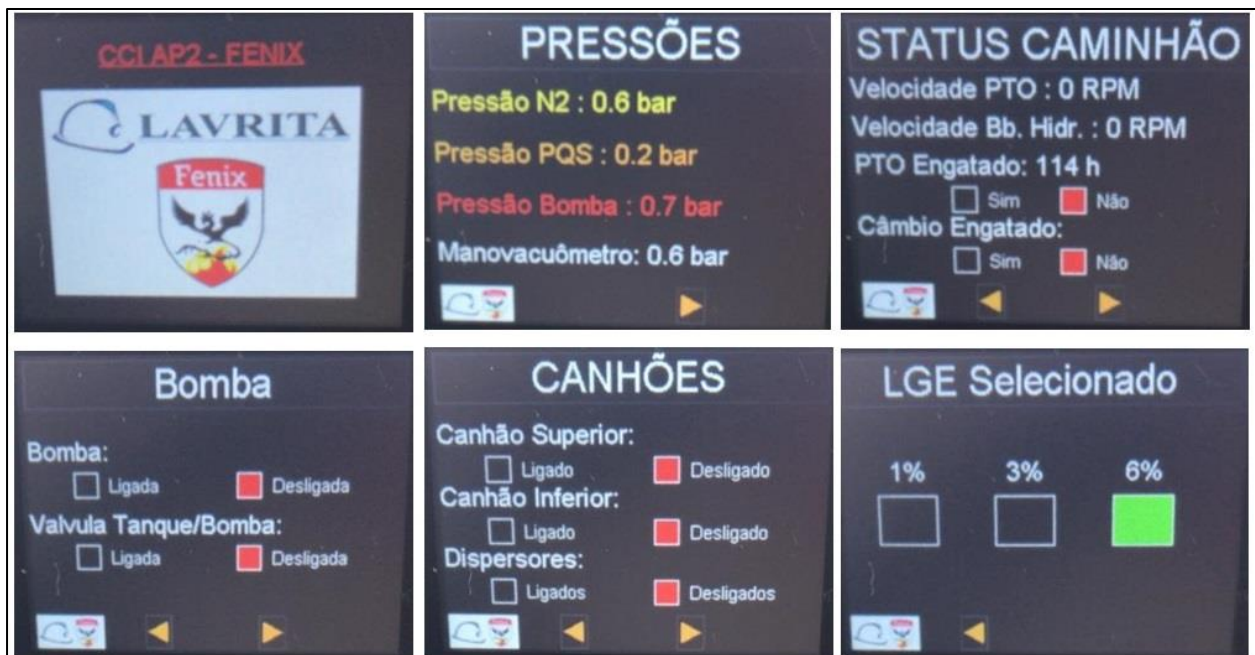
Figura 24: Telas do Painel de Supervisão
