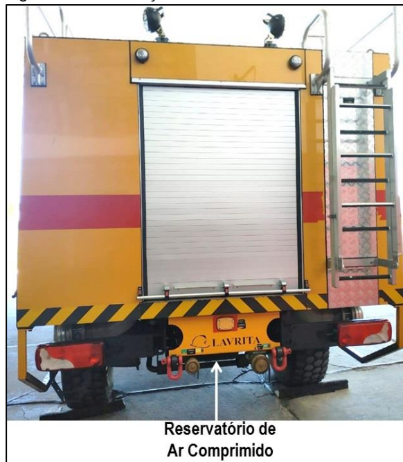
Figura 71: Manutenção Preventiva – Traseira
