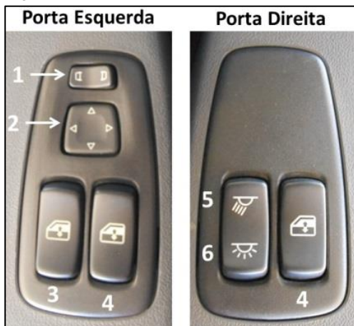
Figura 43: Painéis de Controle de Espelhos e Vidros
