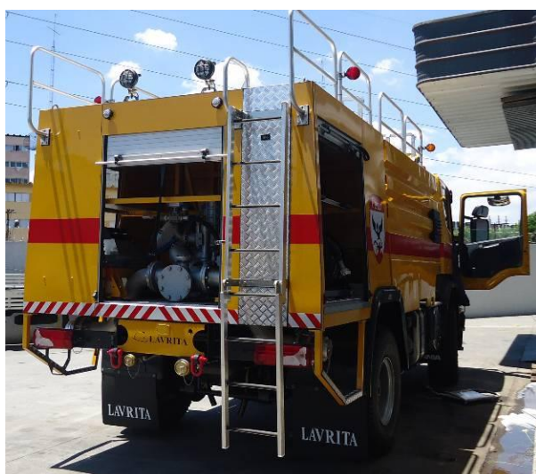
ESCADA PARA ACESSO AO TETO
