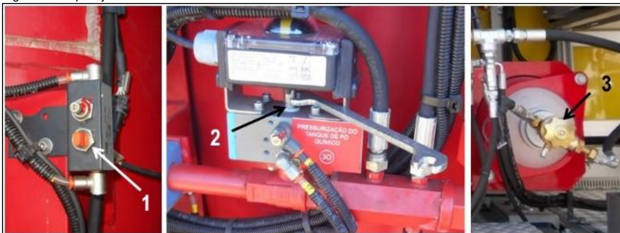
Figura 125: Operação Manual das Válvulas do Sistema de PQ
