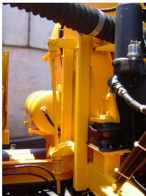
Esticador das correias do acionamento do ventilador
