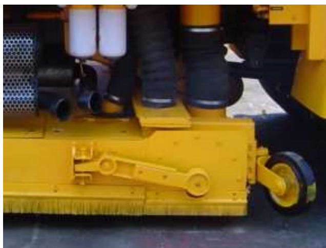
Parafusos de regulagem da pressão de contato da vassoura
