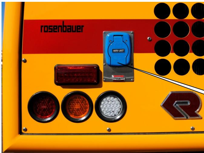
A conexão Auto-Ejetável de 230 Volt 30 Amp (2) está localizada na traseira do caminhão, no canto esquerdo. A conexão Auto-Ejetável fornece potência para o Carregador da Bateria Auxiliar, e o Aquecedor do Bloco do Motor.
