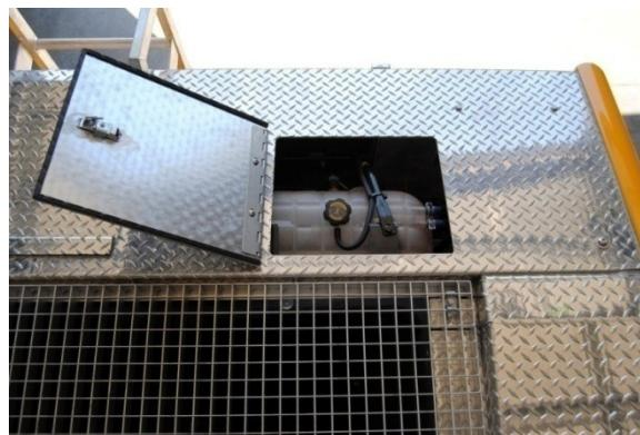
Fique em pé no teto, voltado para a traseira do veículo, com a tampa do reservatório do radiador aberta.
