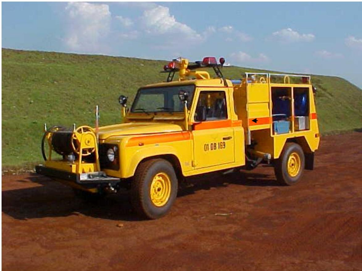
O Carro Contra-incêndio tipo Agentes Combinados Classe 1 (AC-1) é uma viatura montada pela Gascom / Rontan em chassi Land Rover modelo Defender 130. Foi projetado e construído para atuar no combate a incêndios em aeronaves nos aeródromos de categorias 1 e 2. É uma viatura leve, potente e rápida, com condições para operar em pistas normais ou em qualquer terreno e sob qualquer condição de tempo, conforme especificações técnicas da Diretoria de Engenharia do Comando da Aeronáutica.
