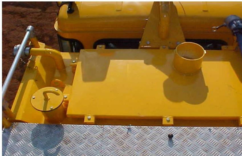
Fabricado pela firma Gascom em chapa 12 de aço carbono SAE 1010/20, com tratamento anti-corrosivo em tinta epóxi amina, capacidade para 700 litros e fixado no chassi por coxins de borracha. Possui em seu interior uma bóia dosadora cuja a finalidade é manter constante o volume de água para a bomba de incêndio, quando da utilização das expedições, principalmente pelo canhão monitor, estabilizando a vazão e o alcance do jato de água.
