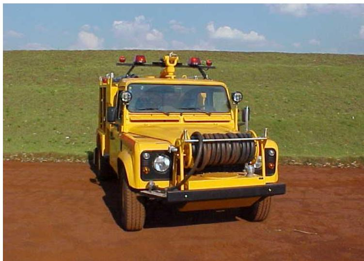
Fabricado pela firma Gascom em aço carbono SAE 1010/20 e revestido em epóxi amina. Composto de um mangotinho de expedição com pressão de trabalho de 300 psi (21kgf/cm<sup>2</sup>), com 25m de comprimento e 25,4mm de diâmetro, esguicho em alumínio e bronze, com regulagens para jato sólido e neblina. Apresenta vazão mínima de 200 l/min e alcance de 15m com jato sólido e alcance mínimo de 6m por 4,5m de largura com jato em neblina.
