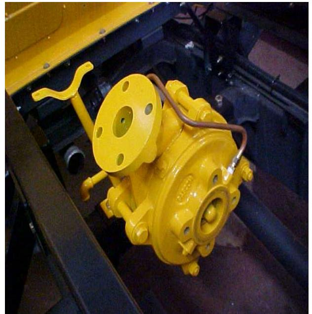
Fabricado pela firma Gascon em alumínio , sendo do tipo centrífuga de 1 estágio e 2 rotores, tendo como com referência BC250AB, Possui vazão nominal de 250 GPM e pressão máxima de 200psi (14kgf/cm<sup>2</sup>). O acionamento é feito pela tomada de força através do conjunto cardam. Sendo a pressão ideal de trabalho de 10,5 kgf/cm<sup>2</sup>
