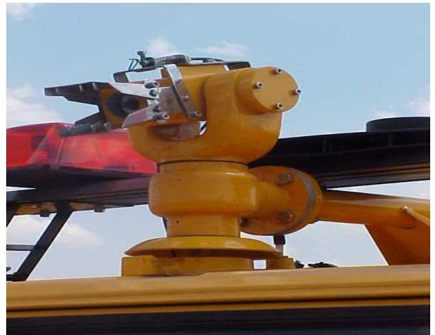
Fabricado pela firma Gascom em alumínio com componentes em aço inoxidável e nylon. Apresenta vazão de 550l/min e alcance de 38m, com jato sólido e alcance de 7,6m por 6m de largura com jato neblina. É instalado sobre o teto da cabine e acionado mecanicamente do seu interior.
